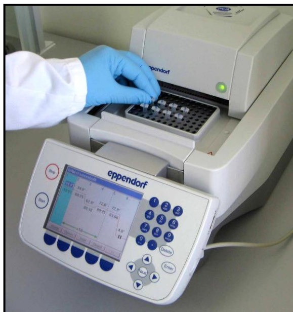
Slika 5. Detalj iz procesa detekcije GMO-a na bazi analize DNK pomoću standardnog PCR
