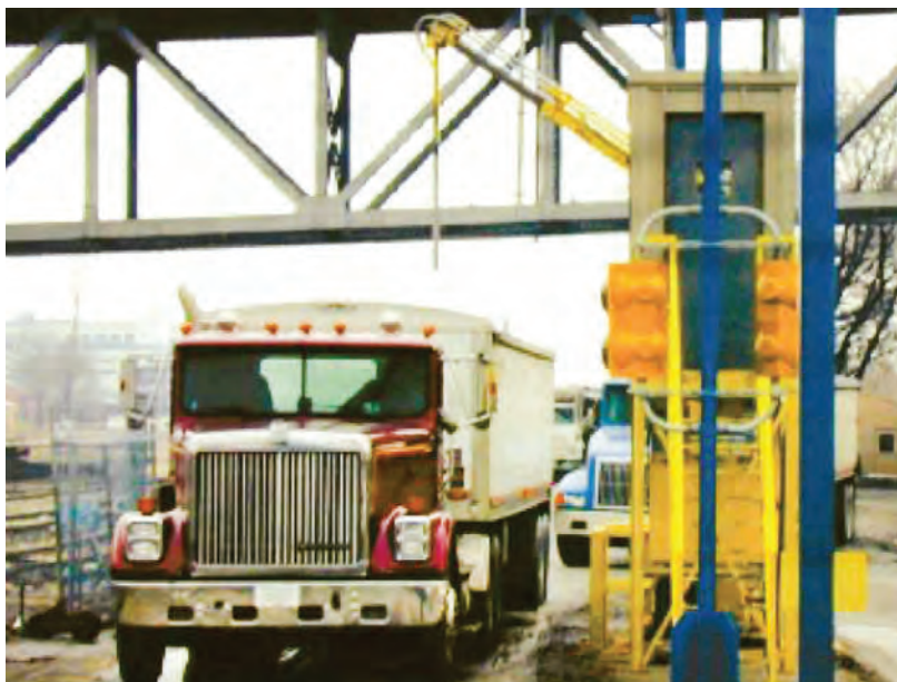
Slika 1. Uzimanje uzoraka za analizu iz pošiljke rasutih poljoprivrednih proizvoda tijekom cestovnog prijevoza
