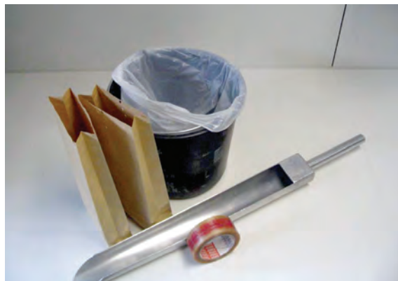
Slika 4. Oprema za uzorkovanje krute hrane za životinje
